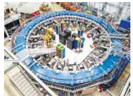
آزمایش Muon g-2 در آزمایشگاه تخصصی Fermilab در یک حلقه ۱۴ متری که دانشمندان در آن یک میدان مغناطیسی ایجاد کردند، صورت گرفت.
